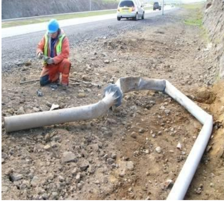
Mynd 21: Ljósastaur á Reykjanesbraut sem virkaði ekki sem skyldi eftir árekstur (EuroRAP á Íslandi 2008: 14).
